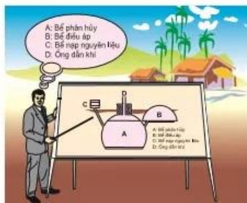
Hình 34.4. Sơ đồ hệ thống biôga xử lí chất thải trong chăn nuôi
