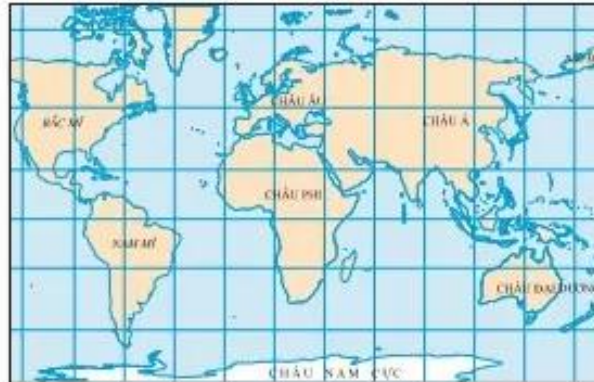
Hình 1.9b - Lưới kinh, vĩ tuyến của bản đồ theo phép chiếu hình trụ đứng
