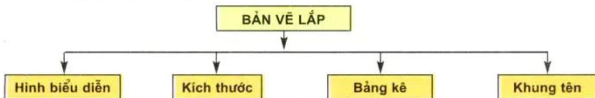
Hình 13.2. Sơ đồ nội dung bản vẽ lắp
