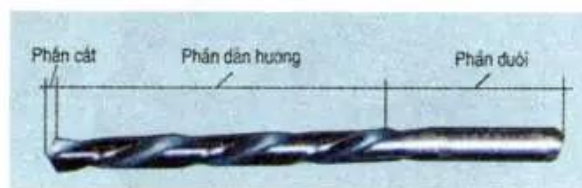
Hình 22.3. Cấu tạo mũi khoan
