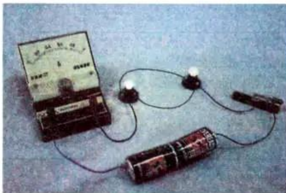
Hình 55.1. Mạch điện chiếu sáng a) Mạch điện thực tế ; b) Sơ đồ mạch điện.
