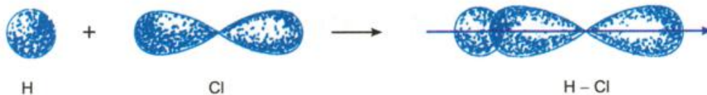
Hình 3.4. Sự xen phủ orbital 1s của hydro với orbital 3p của nguyên tử Cl tạo liên kết H – Cl
