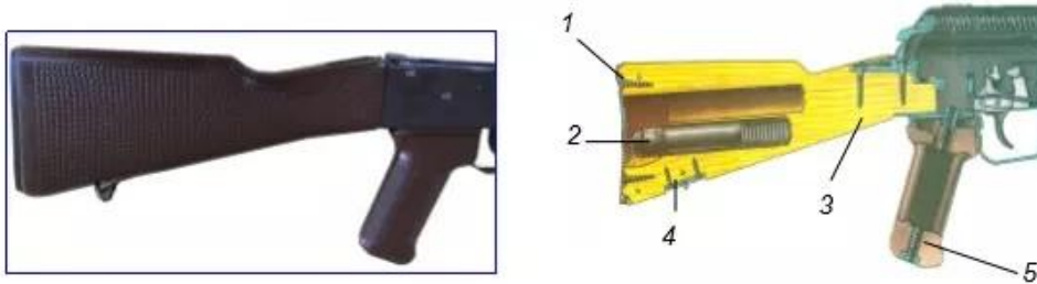
Hình 4-13 . Báng súng và tay cầm 1. Đế báng súng; 2. Ổ chứa ống đựng phụ tùng; 3. Cổ báng súng; 4. Khuy luồn dây súng; 5. Tay cầm.
