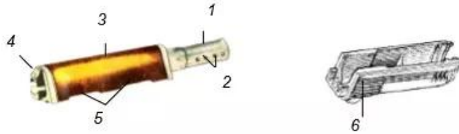
Hình 4-12 Ống dẫn thoi và ộp lót tay 1. Ống dẫn thoi; 2. Lỗ thoát khí thuốc; 3. Ốp lót tay trên; 4. Khâu giữ ộp lót tay và ống dẫn thoi; 5. Khe tản nhiệt; 6. Ốp lót tay dưới.
