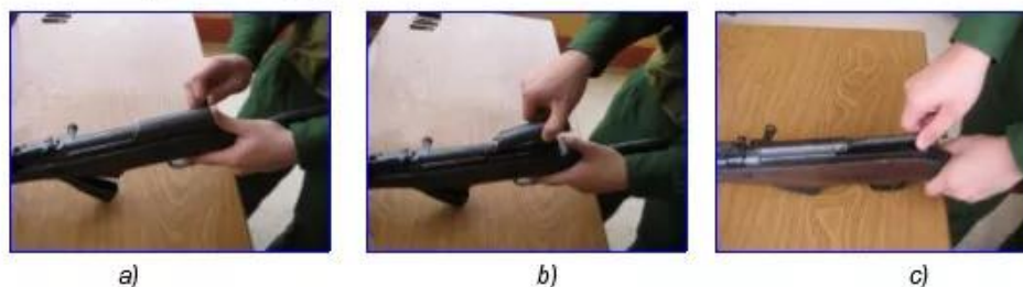
Hình 4-49. Tháo nắp hộp khoá nòng a, b) Tháo nắp hộp khoá nòng ; c) Tháo bộ phận đẩy về.
