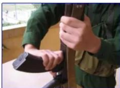
Hình 4-21. Tháo hộp tiếp đạn và kiểm tra súng
