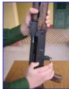
Hình 4-21. Tháo hộp tiếp đạn và kiểm tra súng
