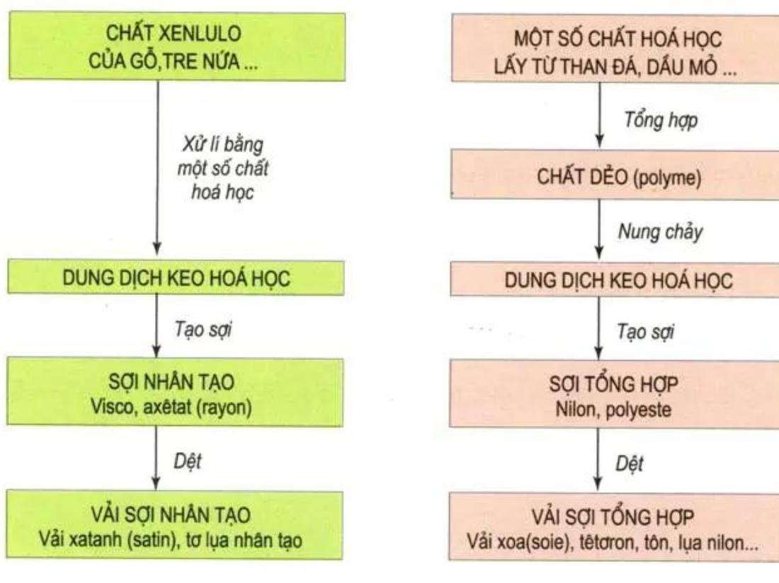
**Hình 1.2** - Sơ đồ quy trình sản xuất vải sợi hoá học.
