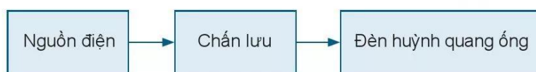
Hình 12.4. Sơ đồ khối nguyên lí làm việc của đèn huỳnh quang ống
