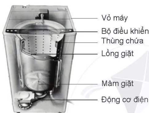
Hình 14.5. Cấu tạo của máy giặt
