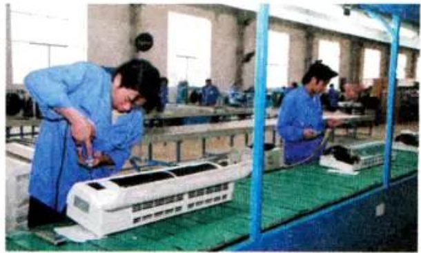
d) Lắp ráp máy điều hoà nhiệt độ
