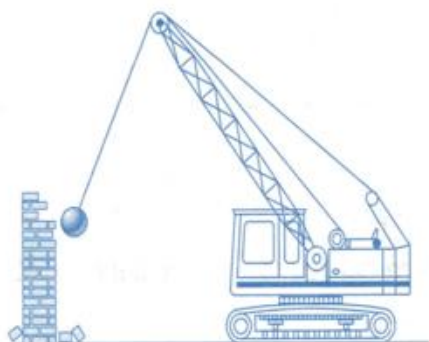
Hình 34.1 Cần cẩu văng quả nặng để phá bức tường
