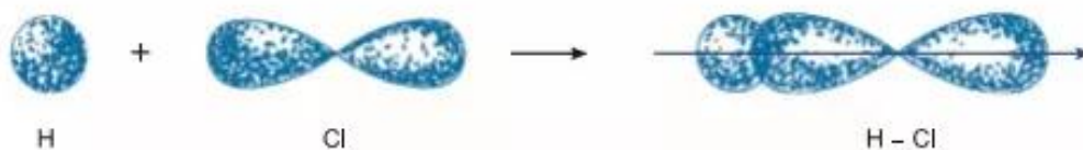
Hình 3.4. Sự xen phủ orbital 1s của hydro với orbital 3p của nguyên tử Cl tạo liên kết H – Cl
