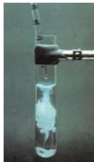
Hình 5.7. Dung dịch \text{AgNO}_3 tác dụng với dung dịch \text{NaCl}
