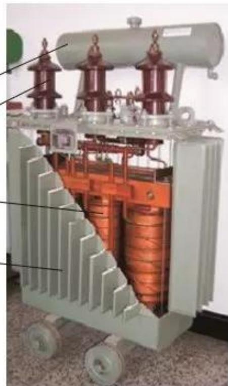
Hình 25– 5. Cấu tạo máy biến áp ba pha
