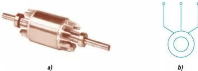
Hình 26 – 5. Hình dạng rôto lồng sóc (a) và kí hiệu động cơ rôto lồng sóc (b)
