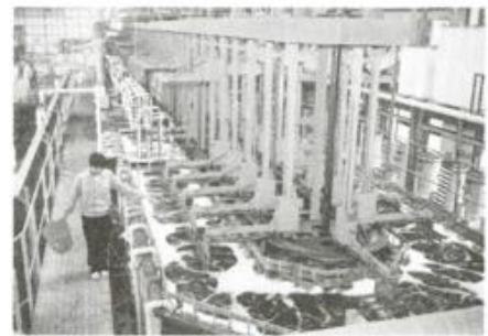
Hình 19.5 Dây chuyền mạ điện trong công nghiệp.
