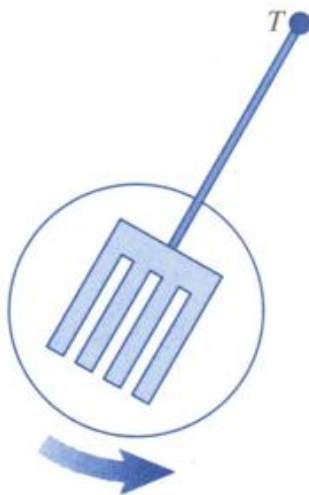
Hình 40.2 Cho tấm kim loại có rãnh xẻ dao động giữa hai cực của nam châm, nó sẽ dao động được lâu hơn.
