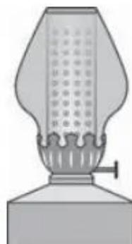
**41.3.** Đèn đất là loại đèn dùng nhiên liệu là  $C_2H_2$  để thắp sáng. Để ngọn lửa cháy sáng và có ít muội than, người ta khoan vài lỗ nhỏ ở sát đầu ống nơi khí thoát ra và cháy.
