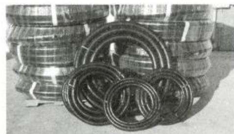
Hình 4.2. Ống dẫn được làm từ PVC
