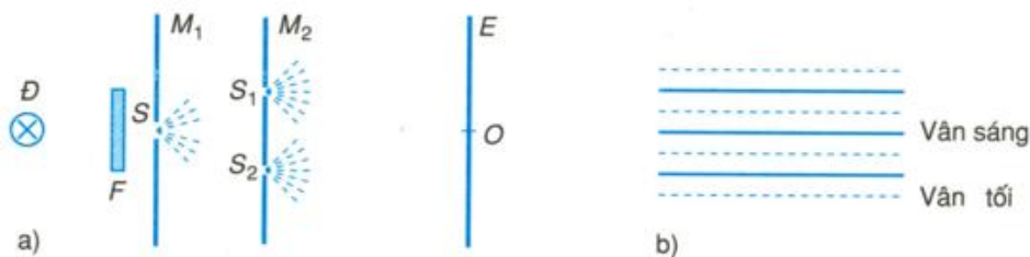
Hình 36.3 Sơ đồ thí nghiệm về giao thoa ánh sáng.
