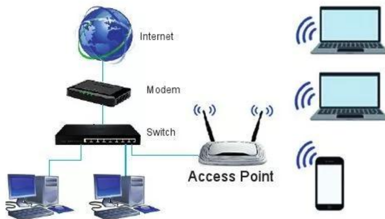
Hình 5. Các máy tính kết nối với Access Point thông qua sóng điện từ
