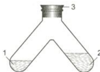
Hình 8.8. Ống nghiệm 2 nhánh đựng nước vôi trong để nhận biết \text{CO}_2 1 – Dung dịch \text{CO}_3^{2-} ; 2 – Nước vôi trong ; 3 – Nút cao su.
