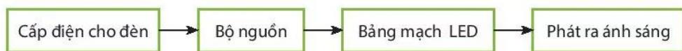
Hình 9.5. Sơ đồ khối mô tả nguyên lí làm việc của đèn LED
