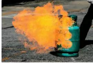
▲ Hình 12.2. Rò rỉ gas gây cháy nổ
