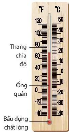
▲ Hình 7.2. Cấu tạo của nhiệt kế
